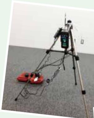
大気中のVOCを吸着管に捕集しています
