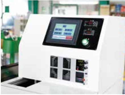
水中ポンプの試験装置。水中ポンプの性能を手軽に試験するために助成金を利用して開発されました。
