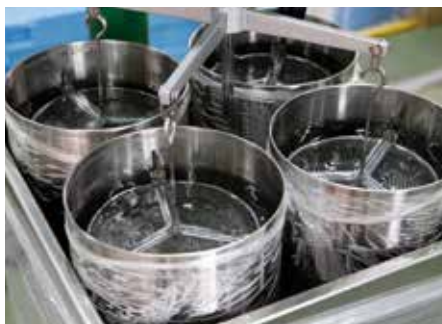
土壌団粒分析器。水の中でふるいにかけることで、土壌のサンプルを粒子の大きさごとに分けることができます。日本だけでなく、中国の研究機関からの問い合わせが多く、輸出も積極的に進めています。
