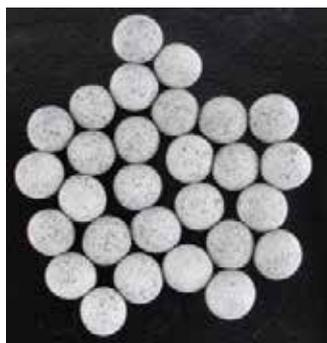
図1 押し出し方式で作製したブラウン管ガラス発泡体
