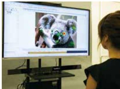
ディスプレイ上の視線を計測できる装置です。頭部に装置を付けることなく測定できます。
