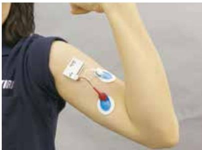
運動または作業中における筋活動を計測できます。最大8か所の同時計測ができます。
