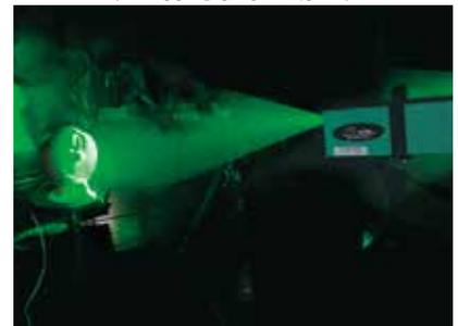
気流などの流体を可視化し、方向や速度などを解析します。微粒子の可視化も可能なので、粒子挙動の時間変化なども解析できます。
