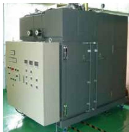
図2 塗装乾燥炉用VOC処理装置
