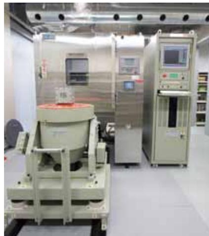
最大振幅40mmpp、最大加速度40Gの加振が可能で、試験品の機械的耐性や接続器具などの瞬断試験等を行うことができます。
