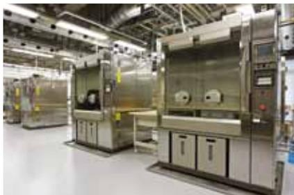
内寸約1m角。操作穴があるため試験品の状態を変更でき、ビデオカメラなどにより24時間内部を監視することも可能です。
