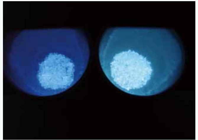
図2 都産技研で試作した炭素ドット蛍光体(365nmの紫外線照射時の様子)
