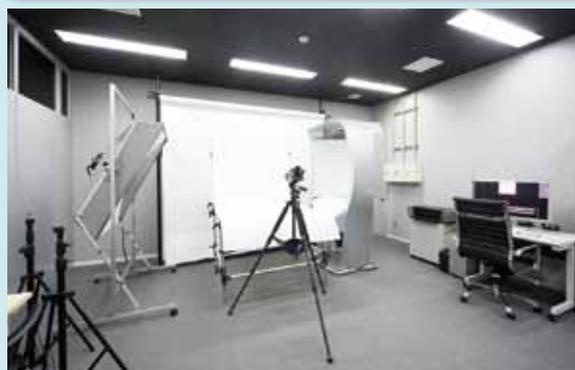
サンプル製品のデータを収集するためにスタジオ撮影システムと組み合わせて高精度撮影を行える装置です。伊勢型紙などの伝統産業などはこれまで素材の高精度デジタル化が不可能でしたが、この装置により解決が期待されます。
