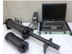
垂直入射吸音率測定装置
