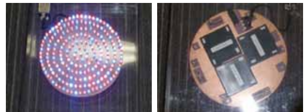
図3 LED点灯回路の実用化事例 左：（表面）照明部分、右：（裏面）回路部分
