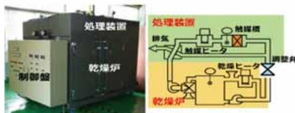
図1 VOC処理装置およびフロー図
