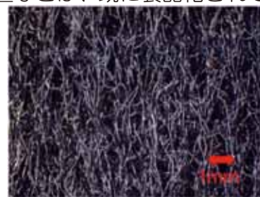
図4 金属繊維フィルター 高温1000℃以上で使用可能
