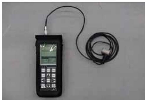
図1 超音波ボルト軸力計
