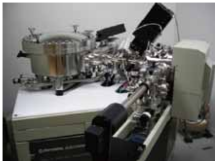
図1 飛行時間型二次イオン質量分析装置 アルバック・ファイ株式会社TRIFTⅢ
