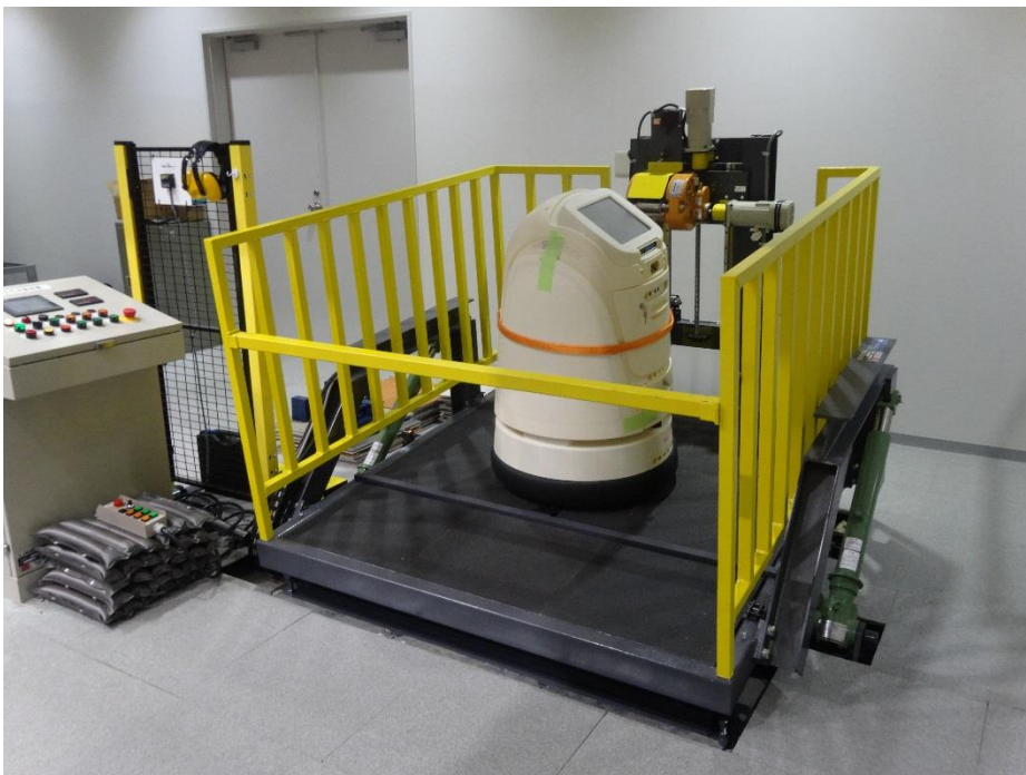
＜移動ロボットの静的安定性試験の様子＞
