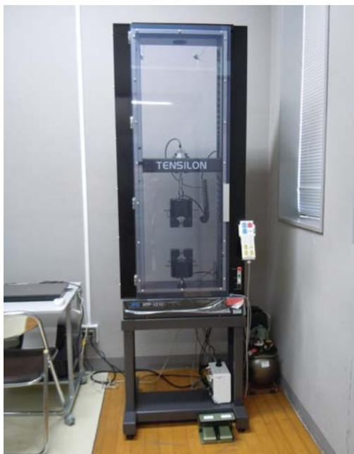
図1 1kN卓上型精密万能試験機
