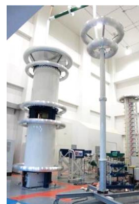
図2 Haefely製電圧発生装置
