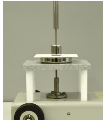
図3 絶縁物試験器のセットアップの例
