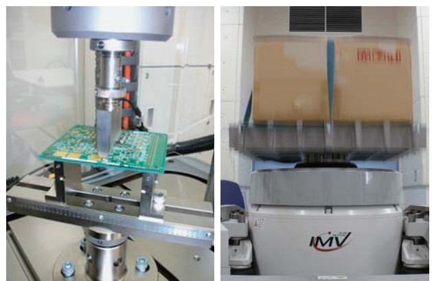
図3 疲労試験(左)と振動試験(右)の様子
