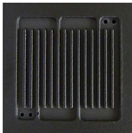
図2 燃料電池のセパレータの流路
