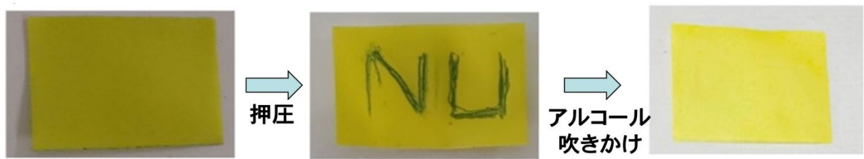
図 3. 押圧により黄色から緑色に変化し、アルコールに接触させることにより元の黄色に戻る。
