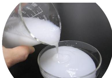
ビーズミルによるセルロース繊維の機械的解繊テスト(左写真)と作成したセルロースナノファイバー分散液の外観(右写真)
