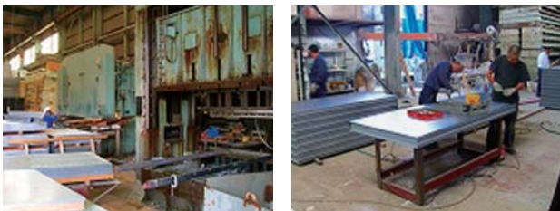
図1 防音パネル加工・組立風景
