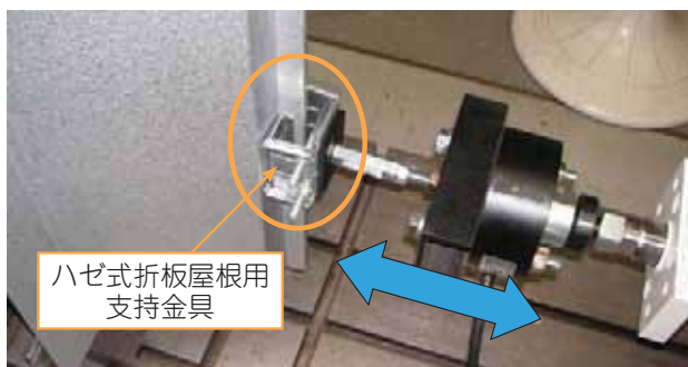
図1 往復動耐久試験装置(上)と都産技研での耐久試験実施状況
