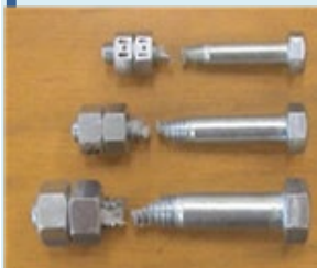
破壊後のボルト
