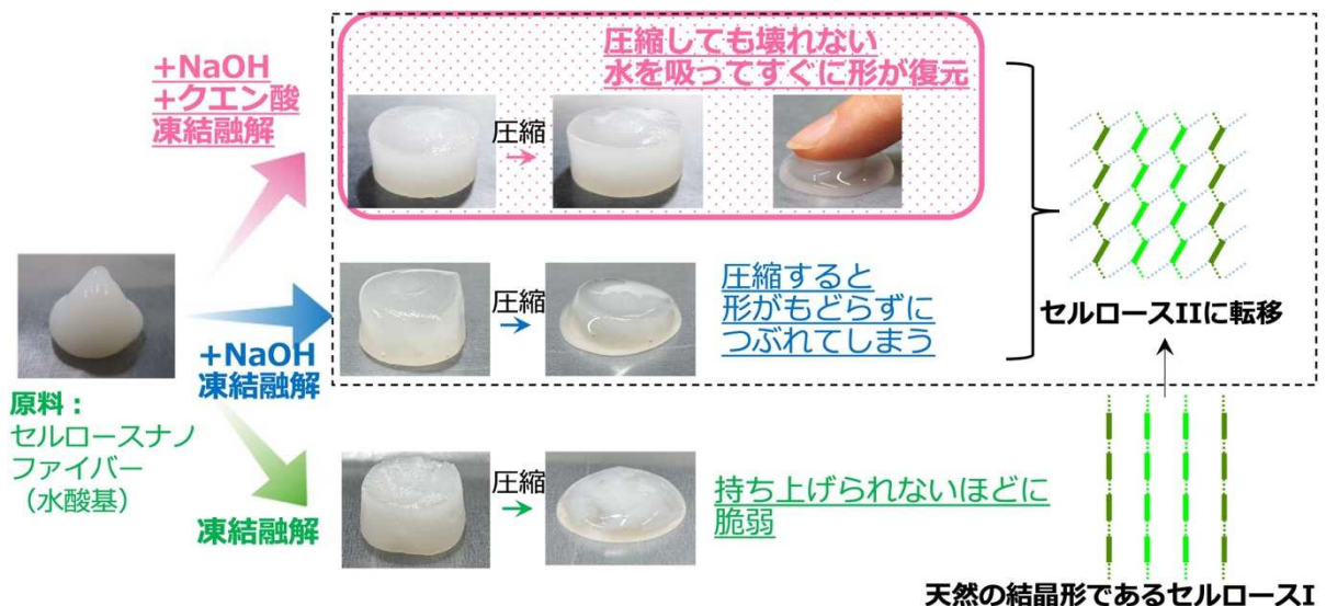
図1 セルロースナノファイバーを原料に高強度セルロース多孔質ゲル材料が生成する条件
