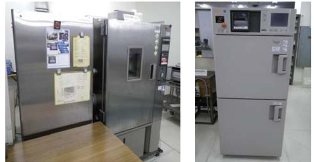
図3 恒温恒湿槽(左)と冷熱衝撃試験機(右)
