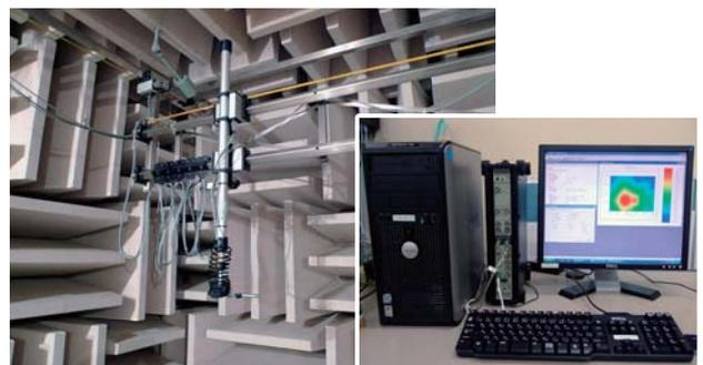
図1 音圧分布測定装置
