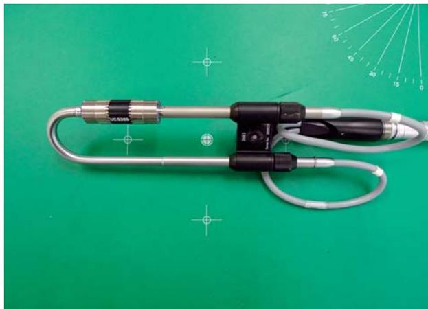
図3 音響インテンシティプローブ
