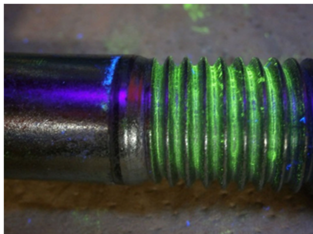
図 ボルトの疲労割れ
