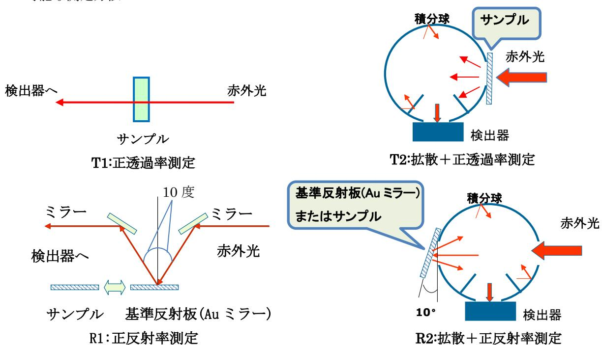
※反射率測定は市販金ミラーを基準反射板に使用します。
