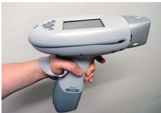
図1 携帯型蛍光X線分析装置外観 装置上面のタッチパネルは、操作と測定結果の表示用です
