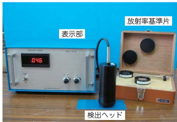
図1 簡易放射率測定器（検出ヘッドと表示部）と放射率基準片
