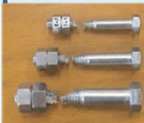
破壊後のボルト
