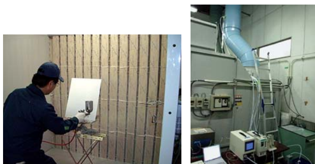
図1 塗装ブースシミュレータ 吹き付け塗装実験とVOC排出ガス分析装置
