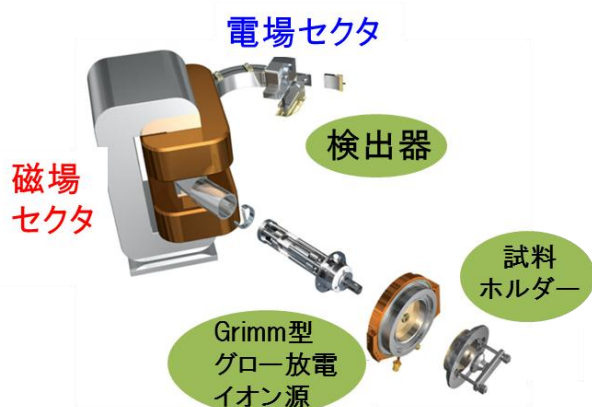
図 二重収束型高感度 GD-MS 分析装置の構成模式図
