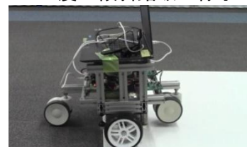
10mmの段差踏破の様子
