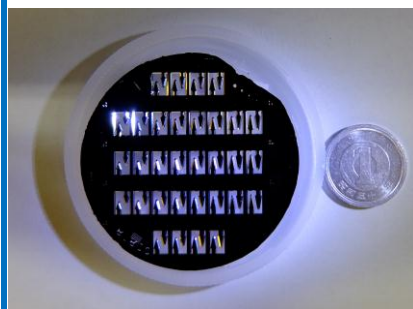
シリコンウエハの加工例 φ50mm 単結晶シリコン
