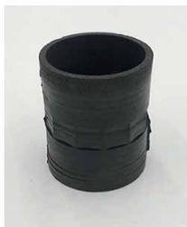
図1 メラミン樹脂による成型品
