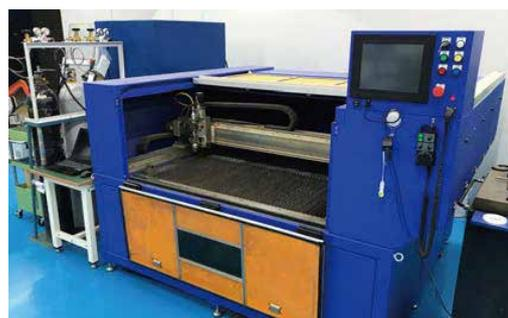
積層金型の加工にファイバーレーザー加工機を使用することにより、低コスト短納期での金型製作を実現しました。
