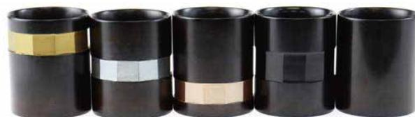
同一の金型で圧縮成型したさまざまな意匠のぐい呑みが試作でき、外観のデザイン評価に加えて手触りや使用感の比較確認が可能となりました。
