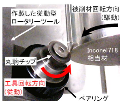
図1 従動型ロータリー切削
