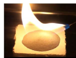
図1 小ガス炎着火試験
