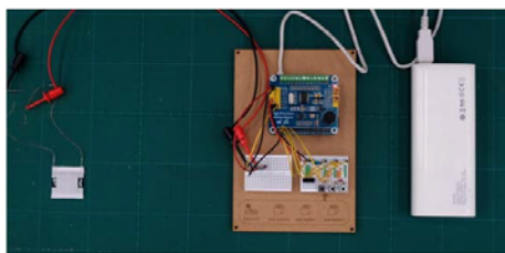
充電電池で動作する計測システムを試作
