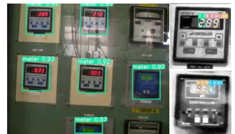
図3 実工場pH計の画像認識結果例
