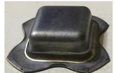
図3 角筒プレス成形例2 (Ti-6Al-4V合金、初期板厚0.5 mm)
