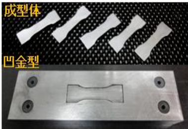
凹金型形状の板材を一度の成形で作製可能
