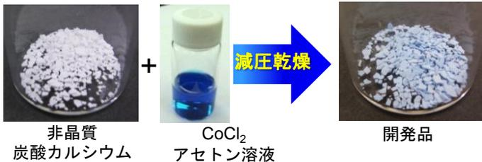
◆ 非晶質炭酸カルシウムと塩化コバルトを混ぜるだけで作製できます。
