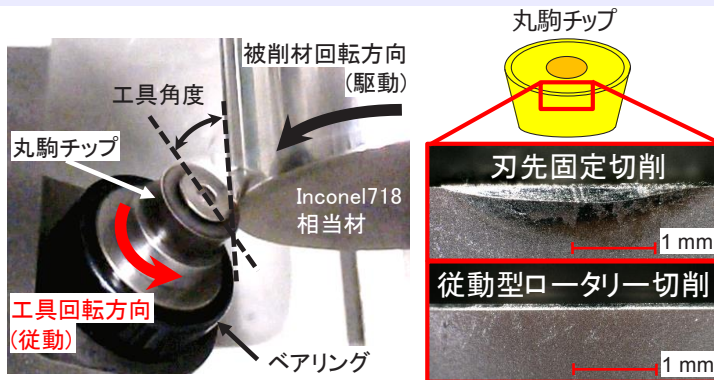
図1 従動型ロータリー切削
