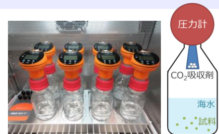
図1 BOD測定の様子(左)と装置模式図(右)
