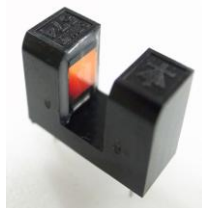
センサヘッド試作例 14×5×h10mm
