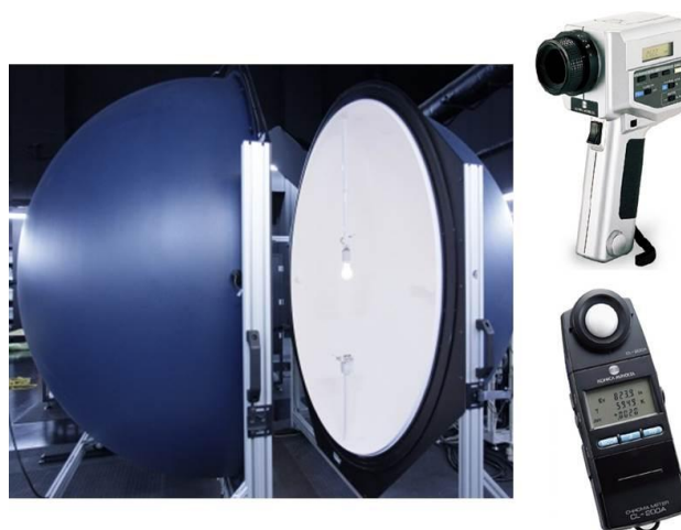
適用可能な測光設備の例 (上)積分球 (右上)輝度計 (右下)照度計
