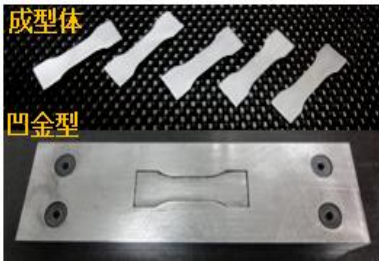
凹金型形状の板材を一度の成形で作製可能
