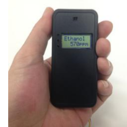
ハンディ型の動作デモ機 センサヘッド寸法 3×4×h2mm
