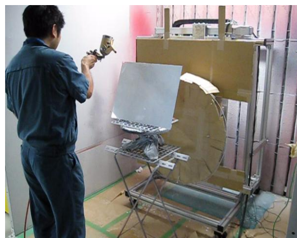
スプレーガン姿勢のセンシング動作検証実験 (吹付液体：水)
