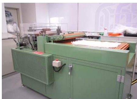
③ニードルパンチ機を用いて不織布化
