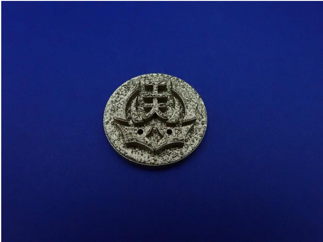
図4 開発した SUS316L ステンレス鋼粉末を用いて造形した名古屋工業大学学章メダル。
