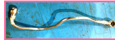
Fueling pipe 燃料供給
