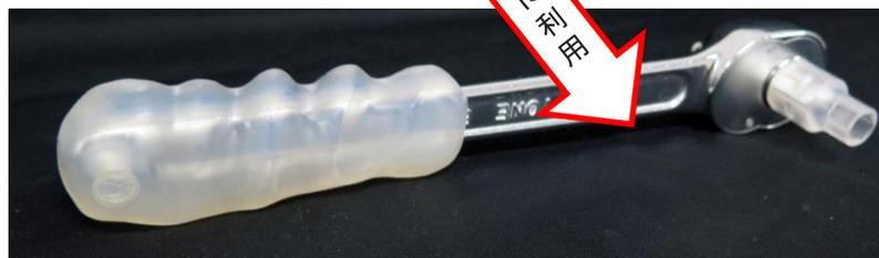
【粘土の原型を元に設計した工具のグリップ】
