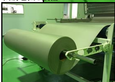
簡易巻出し設備
