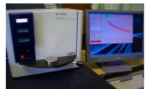
図 3. 開発した PSL 測定装置の写真 (ES-7340A 型)
