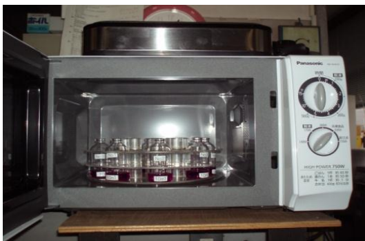
電子レンジとバイアルラックによる加熱
