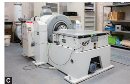
A 同社が開発運用する超小型人工衛星の 1/2 模型 B ボルトの締付けトルクと軸力の関係の評価に使用したねじ締付け試験機 C 完成間近の人工衛星のほか、部品単位での試験も行う中型振動試験機 D 「AxelGlobe Tasking & Monitoring」の操作画面
